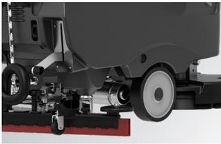
Traction avant équipée de marche arrière pour faciliter les déplacements
